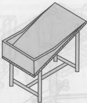
Рис. 5.13. Стационарные гравитационные устройства для передачи полуфабрикатов
