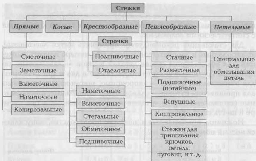
Рис. 1.15. Виды ручных стежков и строчек
