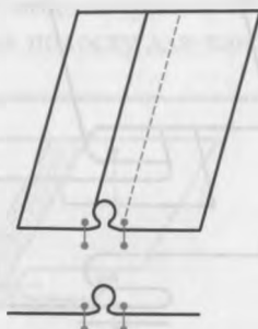
Рис. 1.121. Выстрочной шов без шнура
