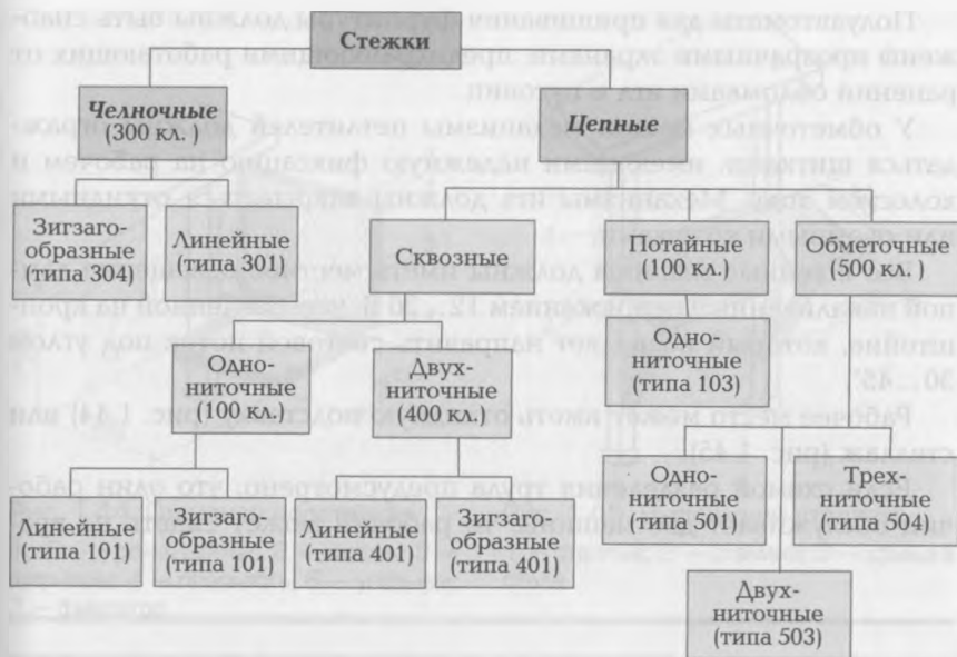
Рис. 1.42. Виды машинных стежков
