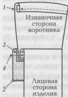
Рис. 2.22. Соединение однослойных воротников с изделием
