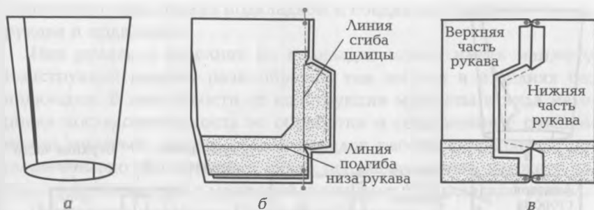
Рис. 3.12. Обработка вытачной шлицы рукава
