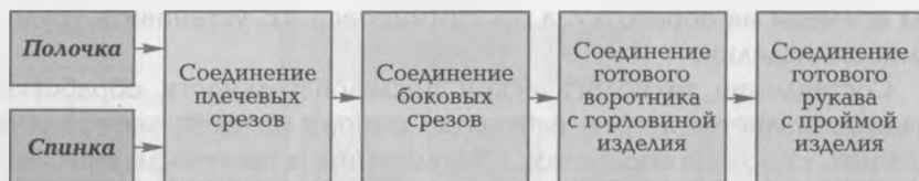
Рис. 5.1. Сборка узлов изделия с втачными рукавами
