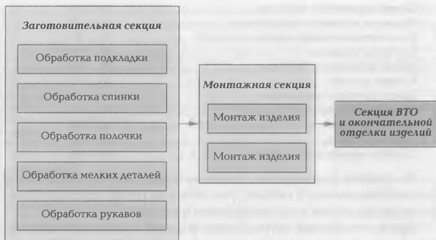
Рис. 5.7. Общая структура технологического секционного потока
