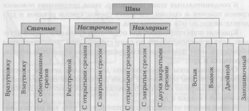
Рис. 1.63. Виды соединительных швов
