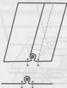
Рис. 1.120. Выстрочной шов со шнуром, выполненный на двух-игольной машине
