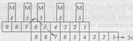
Рис. 5.17. Пример движения гнезда конвейера при кратных операциях и K = 3
