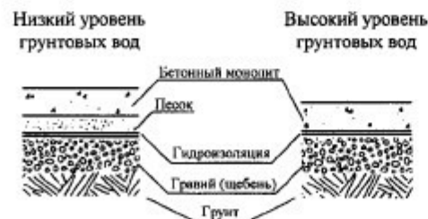
Лист 7. Решения монолитных плитных фундаментов
