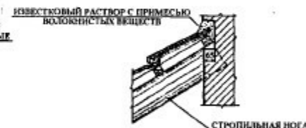
Примыкание кровли к стене вдоль ската
