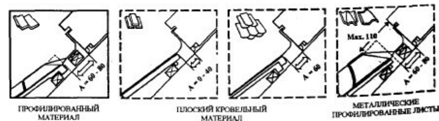
Зазор "А" при различных материалах кровель
