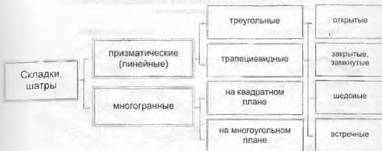
Рис. 2.5. Классификация покрытий в виде складок и шатров
