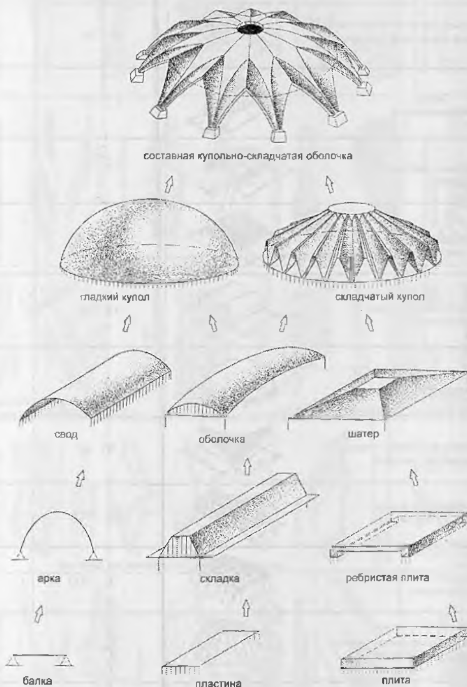
Рис. 2.1. Эволюция пространственных конструкций в виде оболочек и складок
