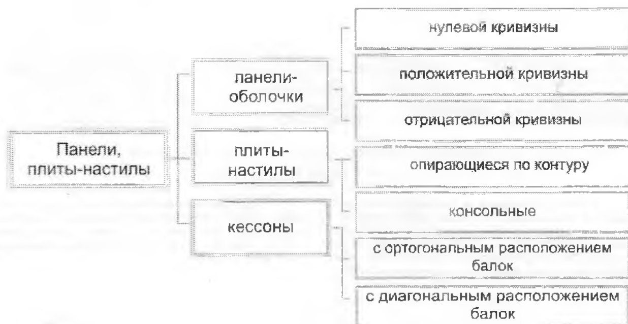
Рис. 2.4. Классификация покрытий в виде панелей-оболочек и плит-настилов
