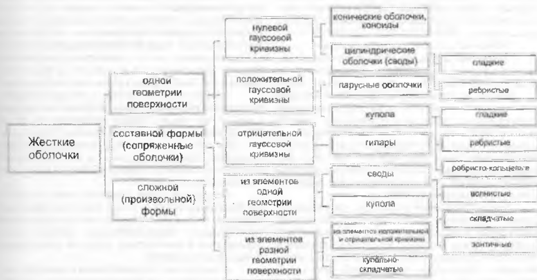
Рис. 2.4. Классификация пространственных покрытий в виде жестких оболочек
