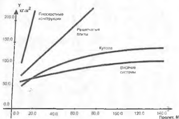
Рис. 1.7. Зависимость расхода стали от величины перекрываемого пролета для различных типов несущих систем
