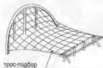
Многопролетная система с вертикальными арками
