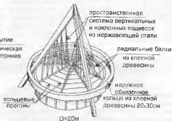
С опорами в виде трех наклонных пилонов
