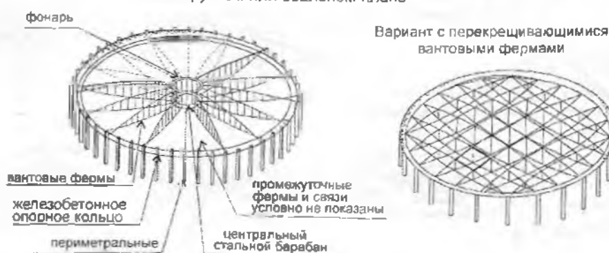
Рис. 4.8. Двухъярусные покрытия на прямоугольном (а) и овальном (б) плане
