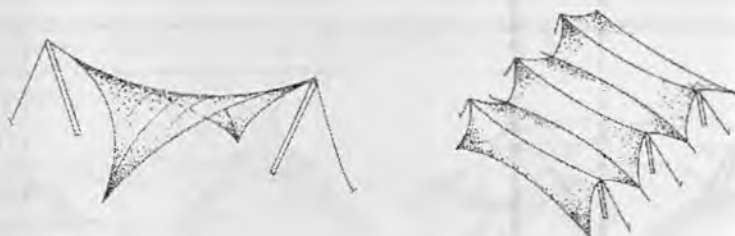
б. Оболочки с жестким опорным контуром
