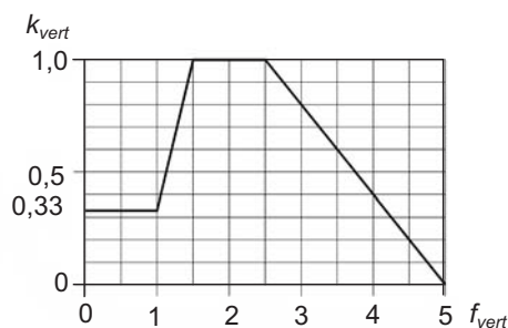
Рисунок В.1 — Соотношение между основной собственной частотой вертикальных колебаний f_{vert} и коэффициентом k_{vert}
