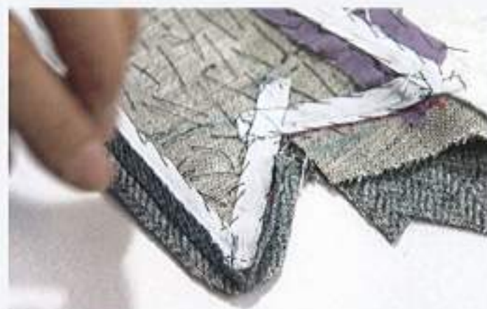
Vue de l'angle du revers dégarni et ouvert au fer avant de retourner celui-ci. View of untrimmed angle of lapel, ironed open before being turned.
