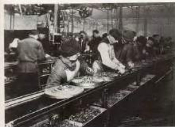
Изготовление маховиков двигателя автомобиля Модель Т, 1914
